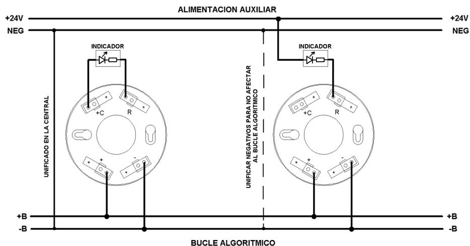
El indicador de acción se puede alimentar desde el propio detector teniendo en cuenta el consumo total del bucle o mediante alimentación auxiliar.
